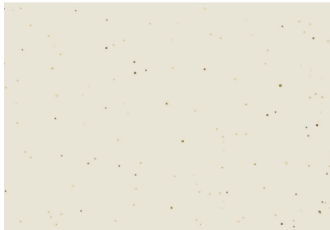
Fig. 1 (arriba) - Al usar tarjetas de detección, un umbral de acción común es de aproximadamente 150 manchas en una tarjeta de 3x5" después de una semana. Este número puede necesitar ajustes según las necesidades de su instalación.
